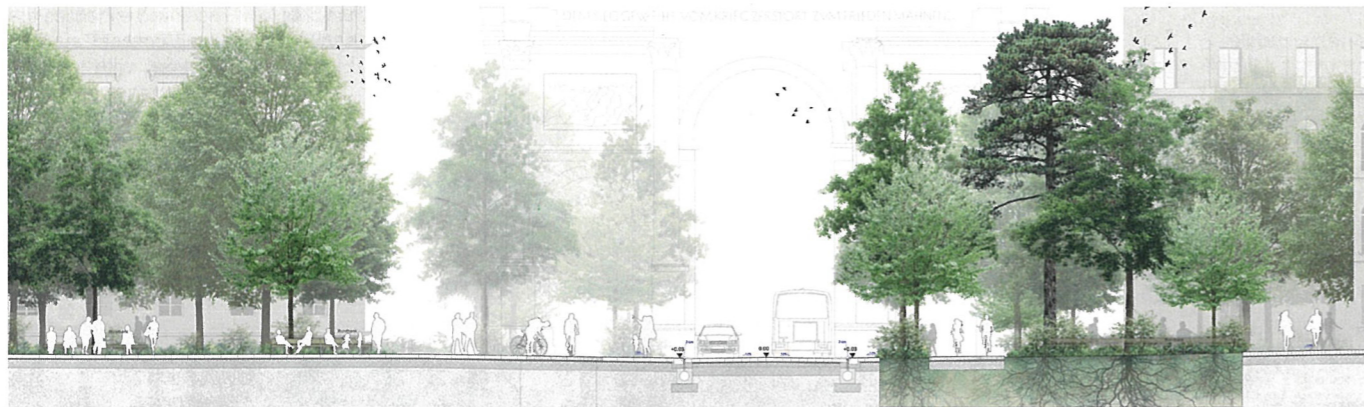
Platzfläche | Pflasterbelag aus Granit mit Rautenmuster | Kreisförmige Intarsien aus Wassergebundener Wegedecke mit integrierten Pflanzflächen
